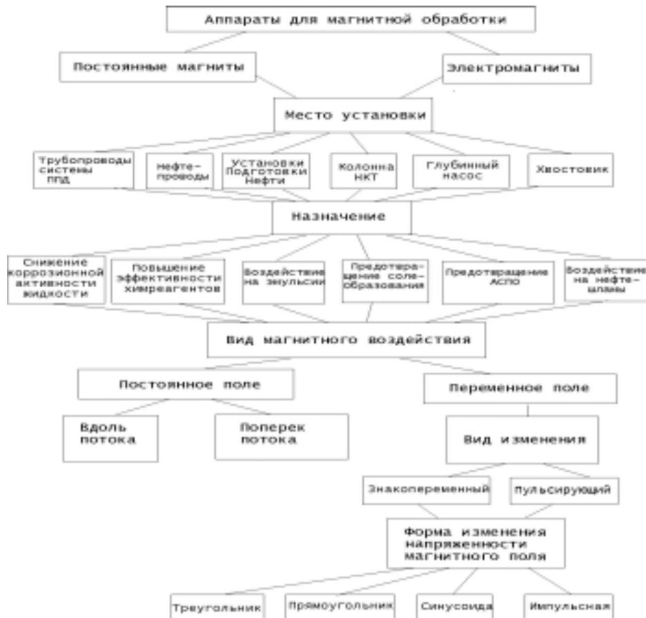
Рисунок 4 – Классификация аппаратов для магнитной обработки
