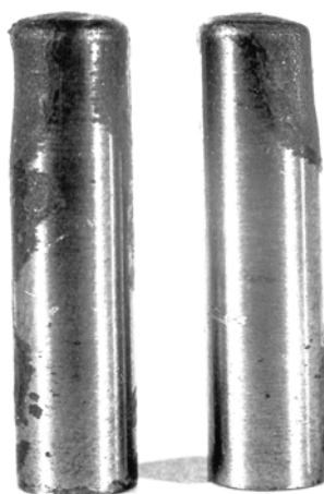
Рисунок 3 – Образцы-свидетели с коррозионно-эрозионным износом металла
