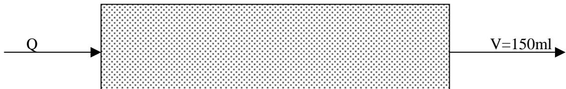
4 Этап. Определение проницаемости кернa через 24 часа
