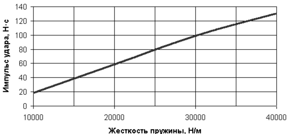
Рисунок 3– График зависимости импульса удара от жесткости пружины
