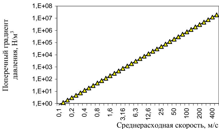
Рис. 1.25. Зависимость поперечного градиента давления от скорости воздуха (диаметр потока 38,0 мм)
