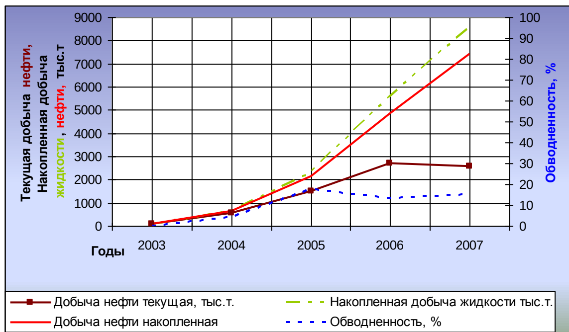
Рис. 2.19. - Текущие показатели разработки объекта AC_{10}^1+AC_{10}^2+AC_{11}^2 южной части Приобского месторождения
