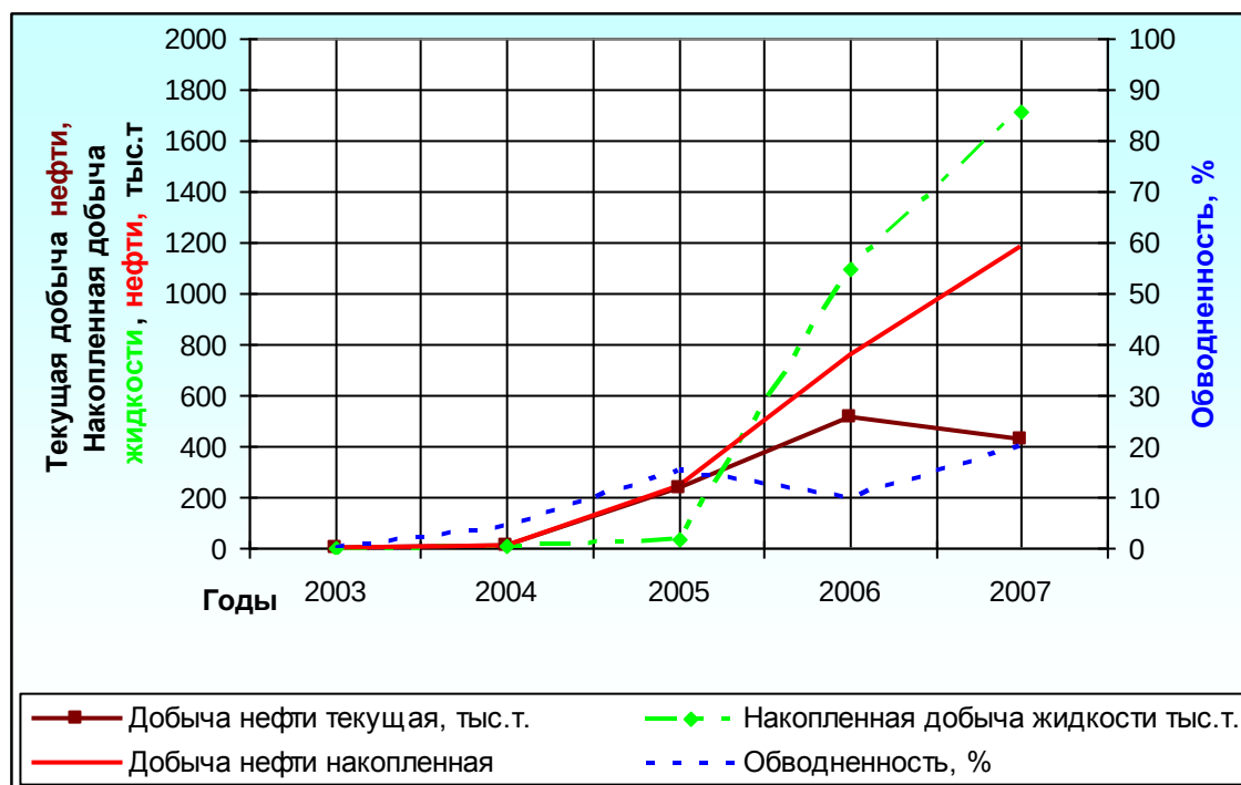
Рис. 2.12 - Динамика основных технологических показателей разработки по пласту AC_{10}^2
