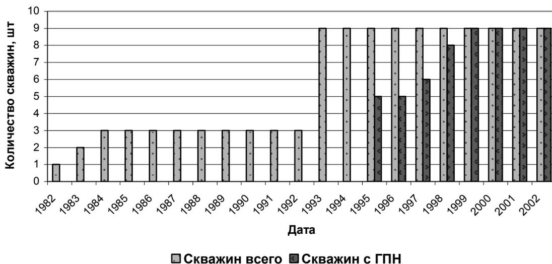
Рисунок 1.29 - Соотношение общего количества скважин и скважин с установками ГСН и ГПН участка пласта БВ<sub>10</sub><sup>1-2</sup> Самотлорского месторождения
