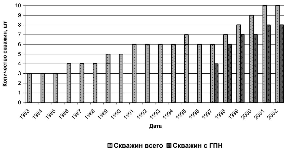
Рисунок 1.13 - Соотношение общего количества скважин и скважин с установками ГСН и ГПН участка пласта АВ<sub>2-3</sub> Самотлорского месторождения
