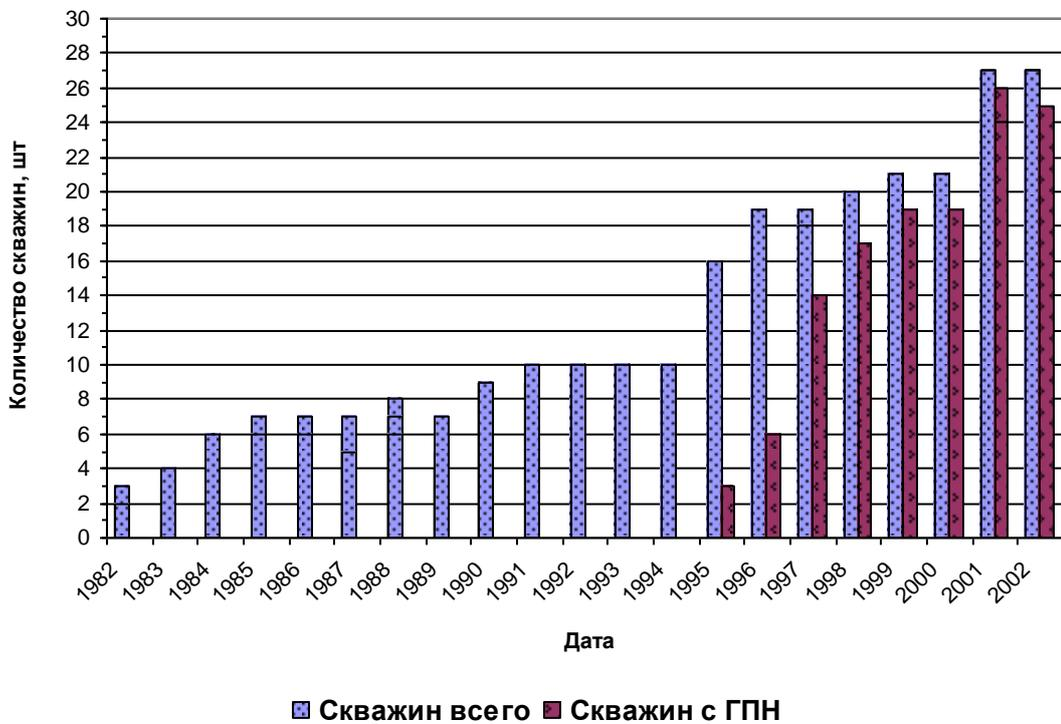
Рисунок 1.7. Соотношение общего количества скважин и скважин с установками ГСН и ГПН участка пласта АВ<sub>1</sub><sup>3</sup> Самотлорского месторождения
