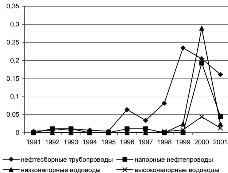
Рис. 7 – Изменение удельной аварийности трубопроводов систем нефтесбора и ППД.
