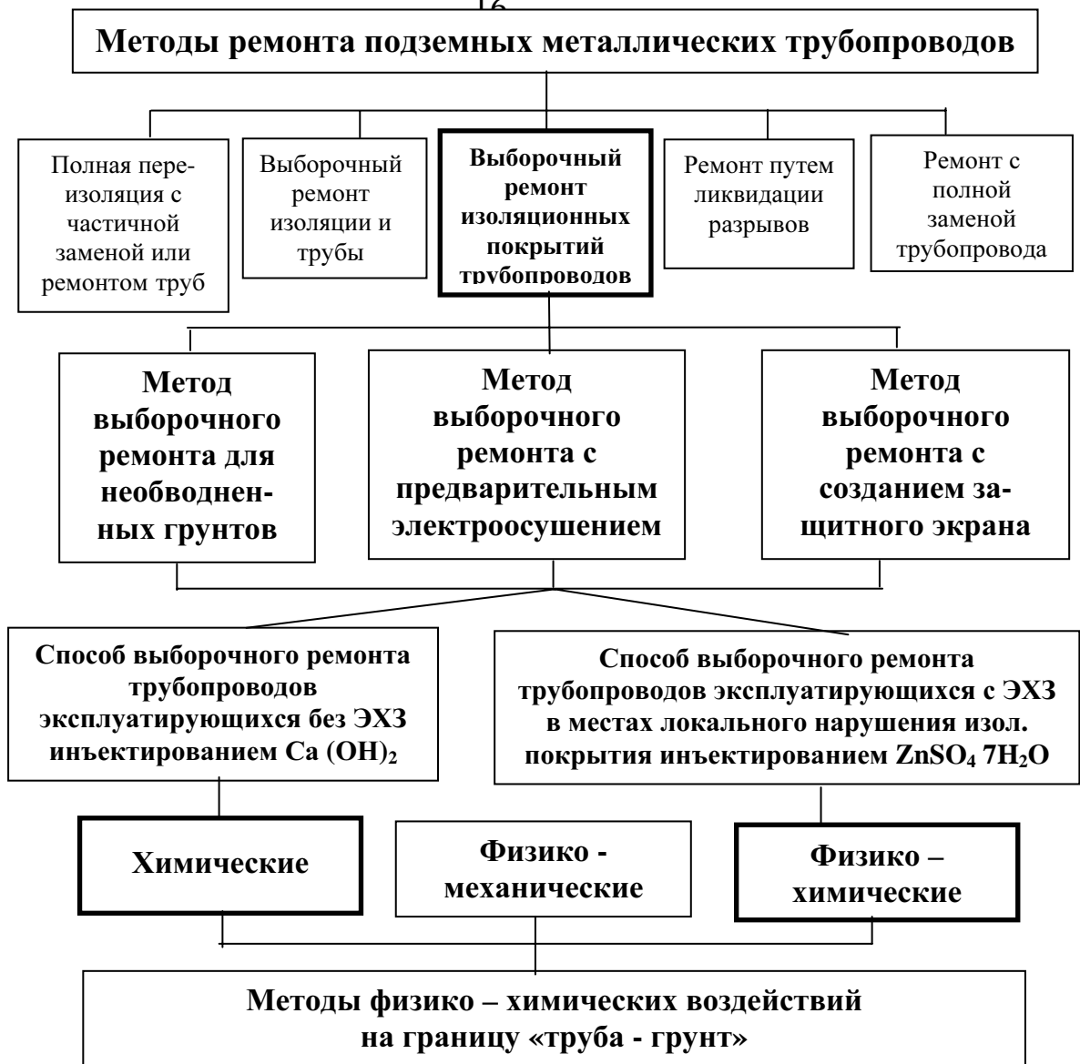
Рис.3 Схема методов выборочного ремонта изоляционных покрытий на основе физико – химический воздействий на границу «труба – грунт».
