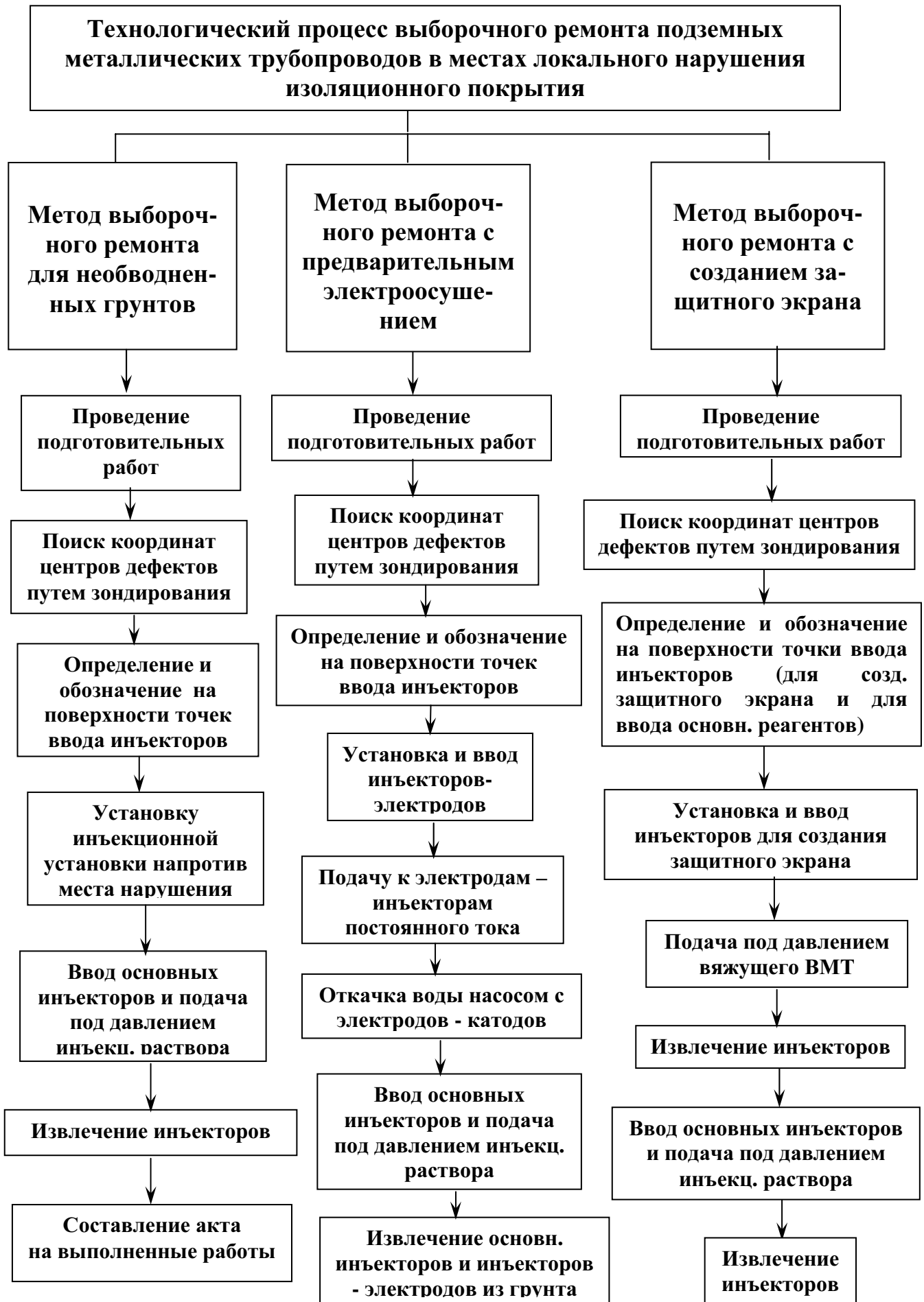
Рис. 4. Технологический процесс выборочного ремонта
