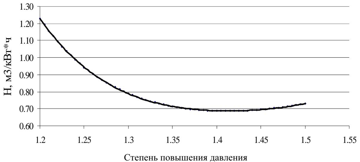
Рис. 5. Зависимость удельного расхода топливного газа от степени повышения давления
