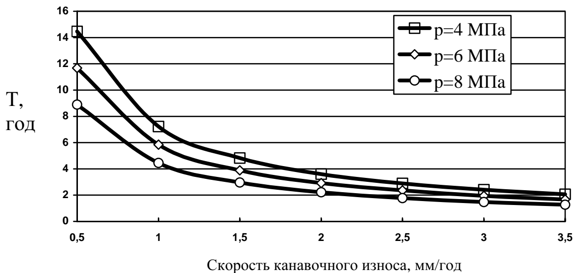
Рис. 20. Зависимость срока безопасной эксплуатации трубопровода от скорости «канавочного» износа
