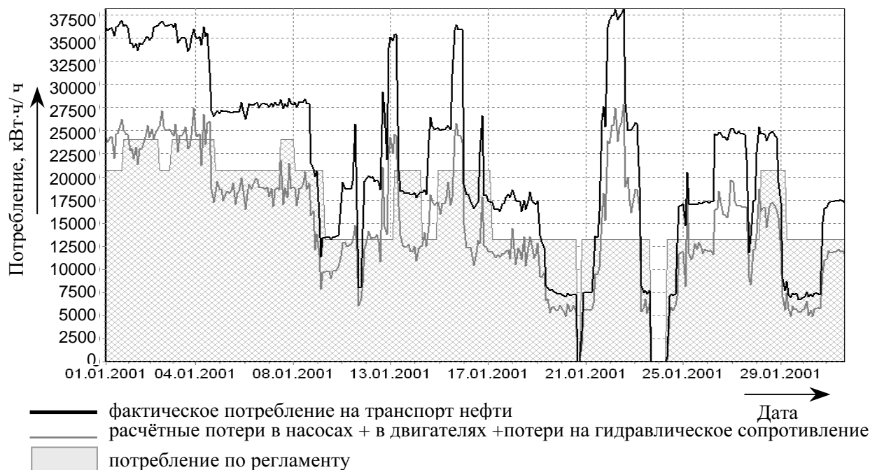
Рисунок 2 - Сравнение энергопотребления магистрального нефтепровода в фактических, регламентированных и расчетных значениях
