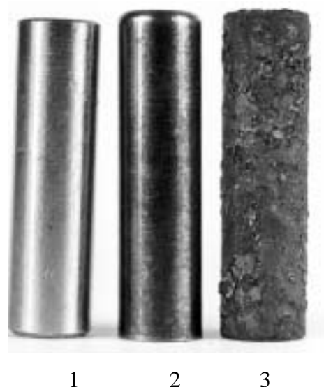
Рис. 5 – Внешний вид образцов-свидетелей до (1) и после экспозиции в водонефтяной эмульсии (2) и в модельной среде NACE (3) в течение 40 суток
