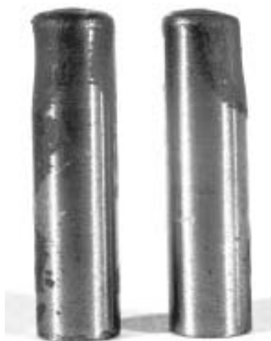
Рис. 2 - Вид образцов-свидетелей, экспонировавшихся на опытном участке
