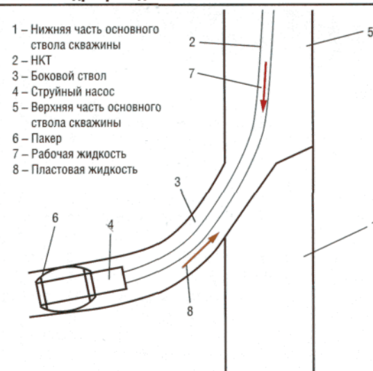
Рис. 7. Гидроприводный насос в БС
